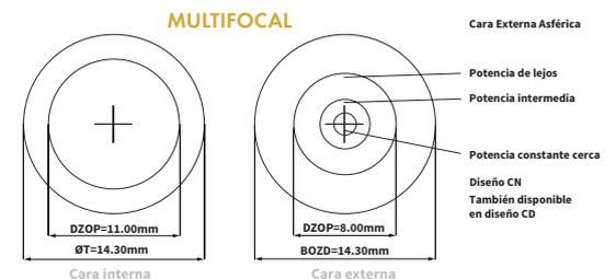
El diseño de la lente es variable en función de la potencia.
